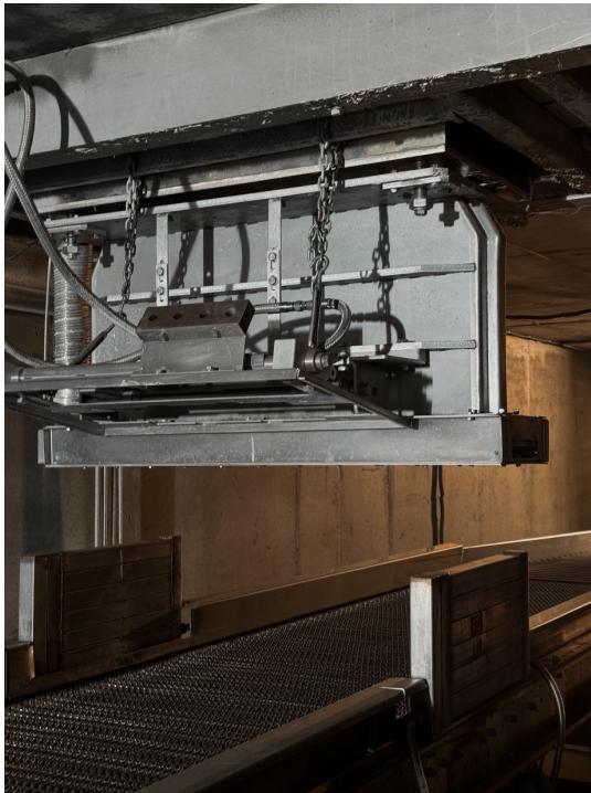
Система развертки пучка ускорителя
