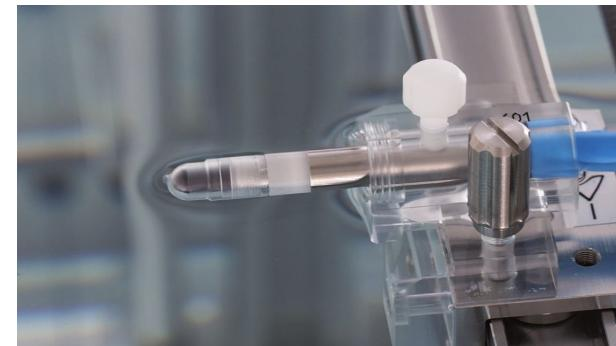
Ионизационная камера PTW Semiflex 3D.
